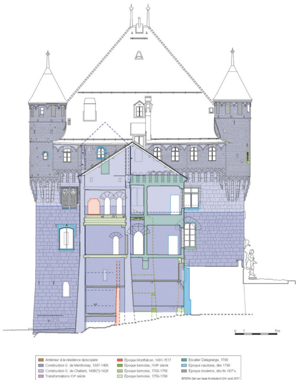
7: Plan simplifié de la façade ouest du château et coupe dans la tour de briques et la cage d'escalier de la fin du 18 e s. (en vert).
