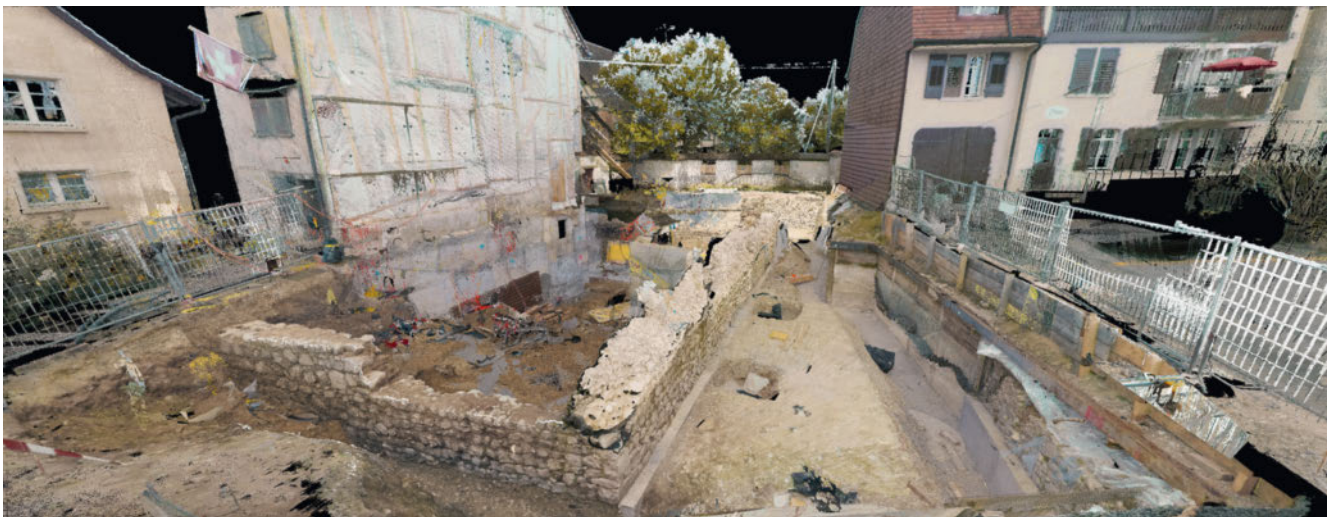
14: Der in mehreren Schritten erstellte 3D-Laserscan erlaubt die digitale Rekonstruktion von Burg und Graben, die während der Untersuchungen nur ausschnitthaft sichtbar waren.
